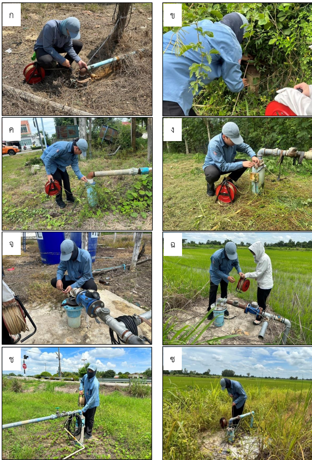
ภาพที่ 5.2.3-13 การวัดระดับน้ำใต้ดินจากบ่อบาดาลในพื้นที่โครงการประตุน้ำโพธิ์ประทับช้าง
