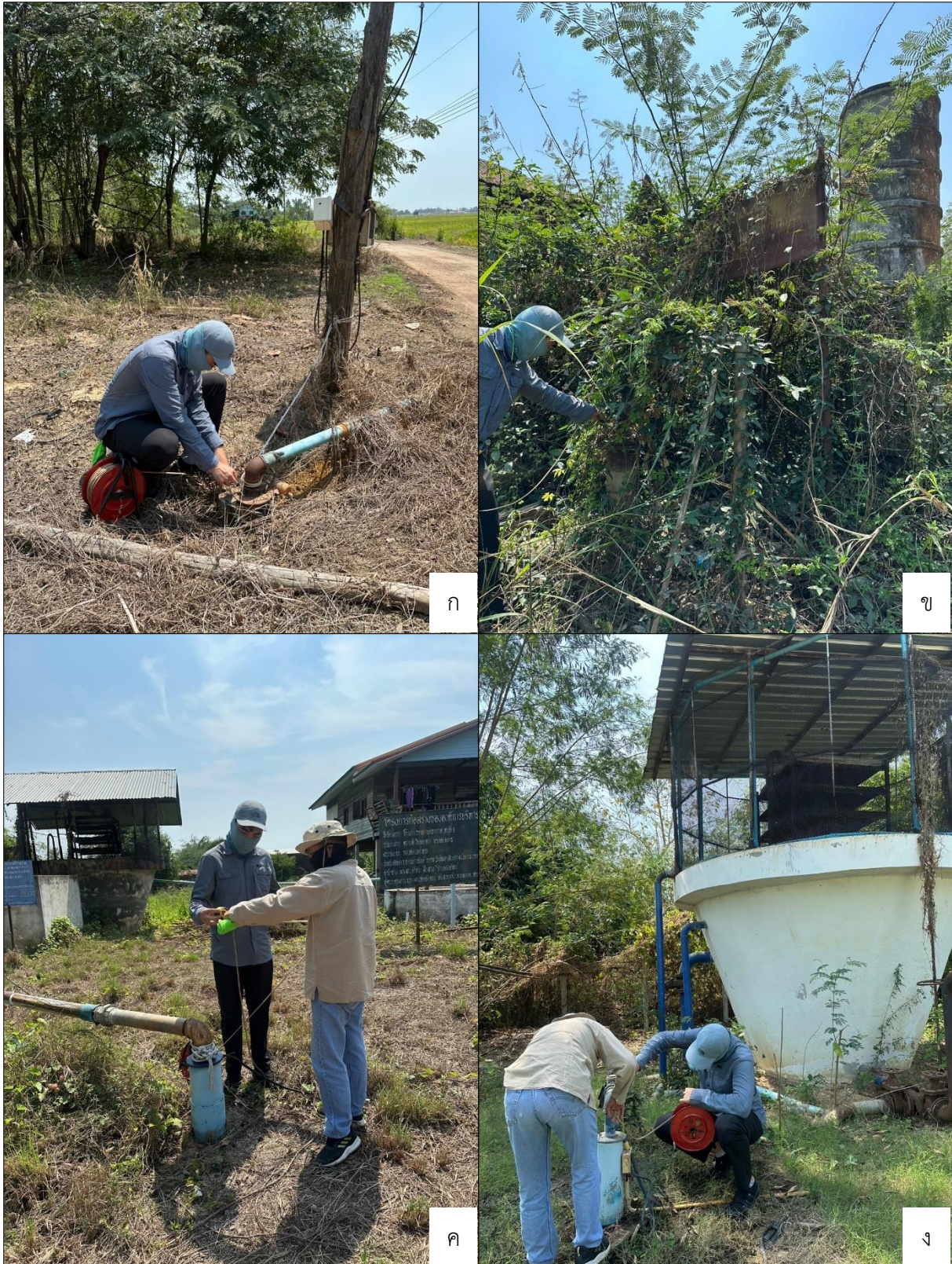
ภาพที่ 5.2.3-4 การวัดระดับน้ำใต้ดินจากบ่อบาดาลในพื้นที่โครงการประตุน้ำโพธิ์ประทับช้าง (ก) TC02 ประปาหมู่บ้าน ช้างบ้านหลังสี่ฟ้า (ข) TC04 บ้านเก่า (ค) TC05 ประปา อบต. บางลาย (ง) TC06 ประปาหมู่บ้านช้างโรงเรียนบางลายพิทย (คอกหมู)
